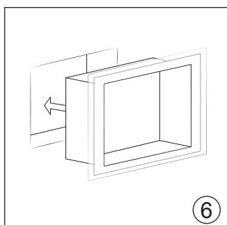
06 Duschnische in die Wandnische einpassen und mit der Wasserwaage kontrollieren.
