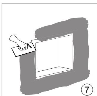
07 Abdichtungsmanschette mit Dichtschlämme z.B. Ardex S7 Plus vollflächig verkleben oder gleichwertiges Produkt.
