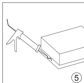
05 Kleber auf die Anschlagsmannchette möglichst flächendeckend auftragen. Kleberempfehlung Ardex CA 20 P oder gleichwertiges Produkt.
