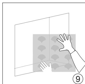
09 Duschnische nach belieben mit Fliesen auskleiden. Kleberempfehlung Ardex CA 20 P oder gleichwertiges Produkt.
